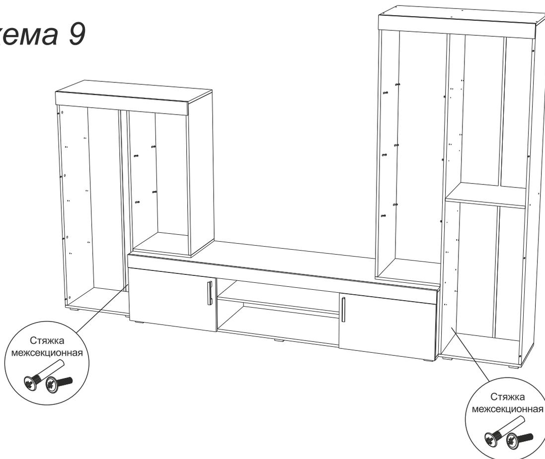
9. Соберите полки верхняя и нижняя: в планку №37 вкните штока эксцентрики в деталь №6 вставьте эксцентрики и закрепите в нее деталь №8 при помощи евровинтов. Деталь №7 и деталь №36 собираются между собой так же при помощи эксцентриковых стяжек как показано на схеме 10.
