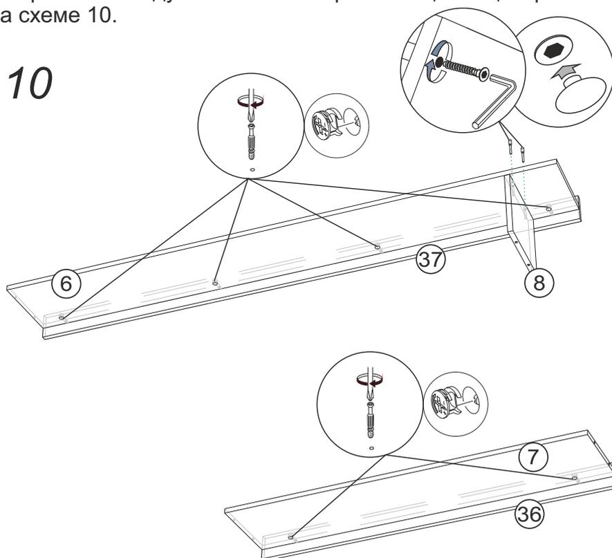
8. Закрепите верхнюю и нижнюю полки при помощи евровинтов к боковинам и крышке шкафа и пенала, затем установите полки и стеклополки как показано на схеме 11
