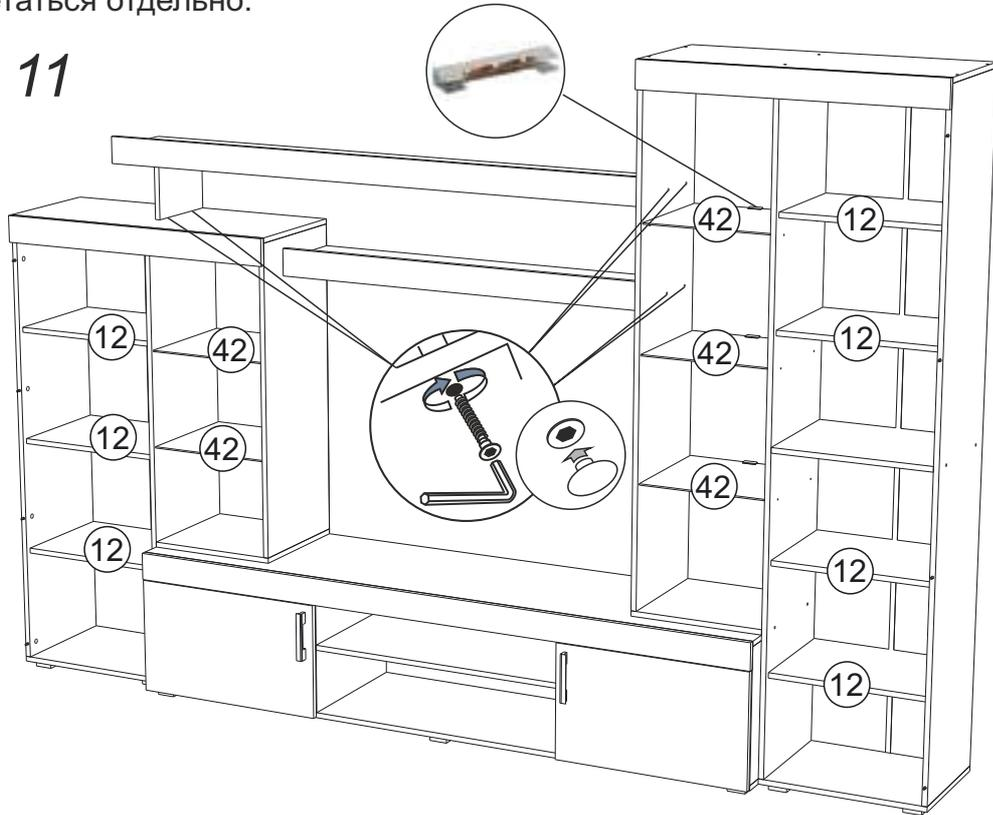
9. Завершающим этапом сборки является установка створок, заранее собранные детали створок закрепите к соответствующим боковинам: Створки №32,38 и 39,28,29 устанавливаются в эксцентриковые стяжки и фиксируются. Створки №27,44 и 43,31 крепятся в ответные планки петель.
