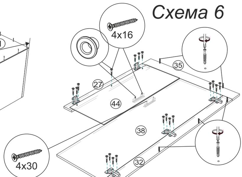
6. Собираем Шкаф. Для этого закрепите всю необходимую фурнитуру на деталях, закрепите между собой Боковину №16 , вязку №13, перегородку №26, затем закрепите деталь №14. Закрепите деталь №11, деталь №25 и в конце закрепите крышку №15 как показано на схеме 7.
