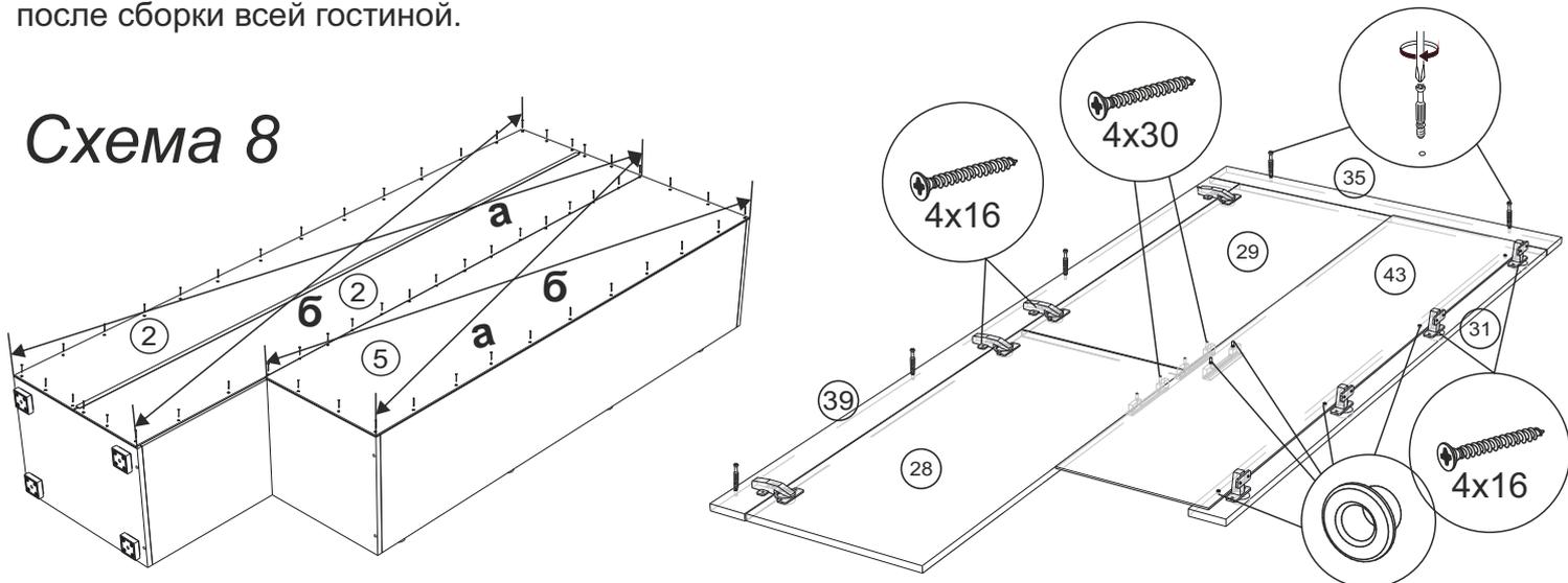
8. Установите пенал и шкаф на тумбу, в боковинах следует самостоятельно просверлить сквозные отверстия диаметром 5мм, для фиксации модулей гостиной с помощью межсекционных стяжек как показано на схеме 9.
